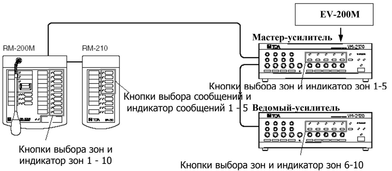
Внимание! При использовании более одной микрофонной панели RM-200M к каждой следующей необходим сетевой адаптер AD-4800. Всего в системе возможно 4 шт. RM-200M.
