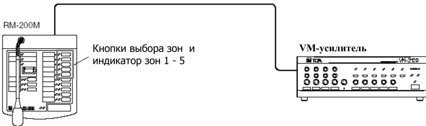
(2) 5 зон с 1 усилителем, оборудованным платой EV-200M.
